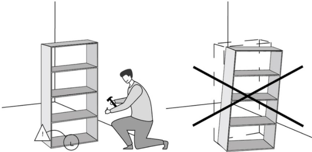
Для исключения поломки мебели не рекомендуется перегружать изделия, больше допустимой нагрузки (стеллажи - 15кг; полки - 10кг; столики - 50кг). Нельзя использовать стеллажи, полки в качестве лестницы.
